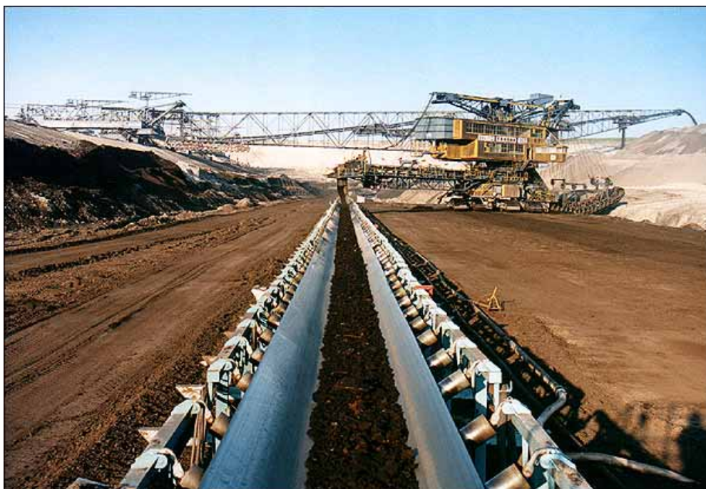
Σχήμα 6.8 . Εξόρυξη του λιγνίτη σε βαθμίδα και μεταφορά του με ταινιόδρομο.
