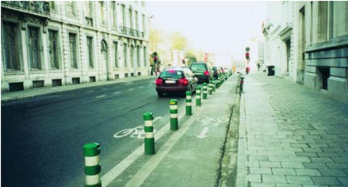
Φωτ. 1.14. Bruxelles. Βέλγιο. Πλαστικά κολωνάκια για την προστασία λωρίδας ποδηλάτου για κίνηση contra-flow. Η ομόρροπη, με τα αυτοκίνητα, κίνηση του ποδηλάτου γίνεται στον ίδιο χώρο με αυτά.
