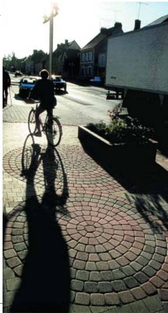
Φωτ. 1.16. Amsterdam. Ολλανδία. Διαμόρφωση ήπιας κυκλοφορίας με αποκλειστικό διάδρομο για το ποδήλατο και μεγάλου πλάτους βαθιά διαχωριστική νησίδα. Η υψομετρική διαφοροποίηση μεταξύ όλων των επιμέρους τμημάτων του δρόμου είναι πολύ μικρή ώστε αισθητικά να αποκτάται μια ενιαία εικόνα.
