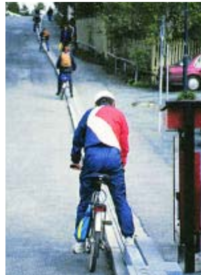
Φωτ. 1.9. Trondheim. Νορβηγία. Νορβηγική πατέ - ντα που προβλέπει την εγκατάσταση στο κράσπεδο μηχανισμού κυλιόμενου ιμάντα, από διάφορα σημεία του οποίου μπορεί να σπριχτεί το πόδι του ποδηλάτη και αυτός ωθείται έτσι μέχρι την κορυφή της ανωφέρειας. (Από σχετικό φυλλάδιο του Public Roads Administration of Norway).
