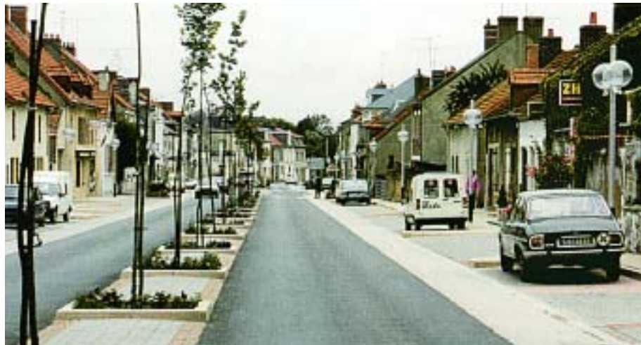
Φωτ. 1.36. Doyet, Γαλλία. Οδόστρωμα, κεντρική νησίδα, ζώνη στάθμευσης, πεζοδρόμια. Κάθε ένα από τα παραπάνω τμήματα του δρόμου έχει τη δική του κατασκευή και αισθητική. Αξίζει να προσεχθεί η μορφή της κεντρικής νησίδας που είναι βαπί. Βρίσκεται μάλιστα στο ίδιο επίπεδο με το οδόστρωμα έτσι ώστε οι πεζοί να διασχίζουν ελεύθερα το δρόμο από οποιοδήποτε σημείο. Η δένδροστοιχία, ανά σταθερές μικρές αποστάσεις, έχει ενταχθεί με επιτυχία στην αρχιτεκτονική της νησίδας που είναι καλυμμένη στο σύνολό της με ένα υλικό που εξασφαλίζει αισθητικά την ενόπιά της. Πρόκειται για μια λύση που ενδείκνυται για δρόμους μεγάλου πλάτους όταν περιορίζεται το οδόστρωμά τους για τη μετατροπή τους σε ήπιες κυκλοφορίας. (Η φωτογραφία παραχωρήθηκε από το CETUR και περιλαμβάνεται στην έκδοση Réduire la vitesse en agglomération, σελ. 25).
