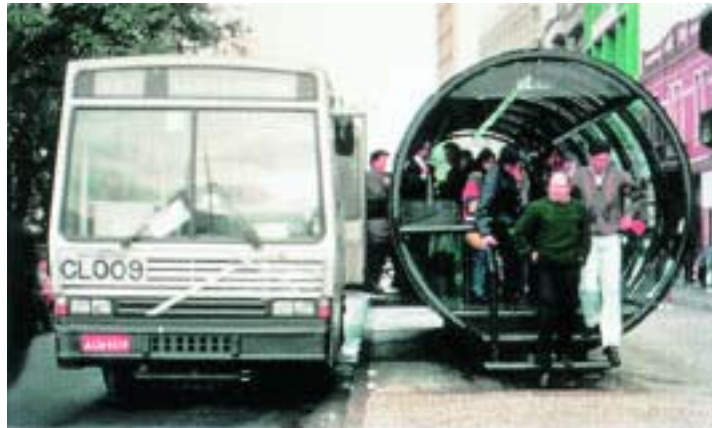
Φωτ. 1.46. Curitiba, Νότια Βραζιλία. Στάση λεωφορείων express χαρακτηριστικής κυκλικής διατομής που ανεβάζουν τον επιβάτη στη στάση του δαπέδου του λεωφορείου. (Από το φυλλάδιο του US Dept of Transportation, 'Bus Rapid Transit Initiative').
