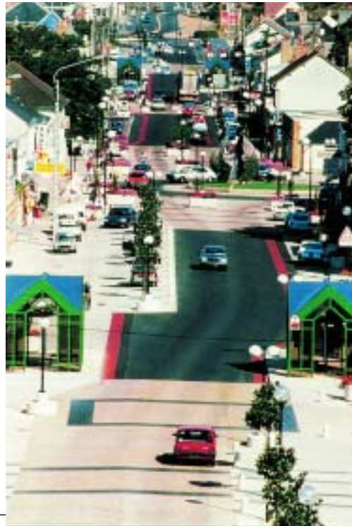
Φωτ. 1.30. Amage. Γαλλία. Χρωματική διαφοροποίηση οδικών τμημάτων. Διακρίνονται οι πύλες - κατασκευές που συμμετέχουν στη σήμανση της έναρξης ενός ενιαίου του οδικού τμήματος που επιπλέον έχει επιστραφεί με έγχρωμο τάπητα. (Η φωτογραφία παραχωρήθηκε από το CETUR και περιλαμβάνεται στην έκδοση Ville plus sûre - Quartiers sans accidents, στη σελ. 152).
